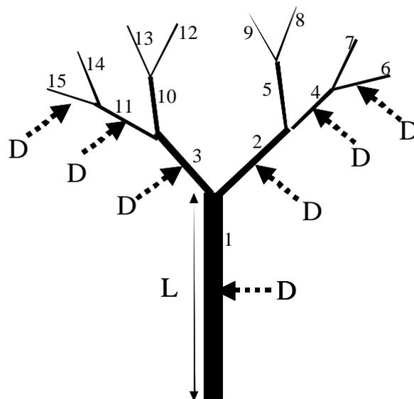
Gambar L.1. Skematis pengukuran panjang (L) dan diameter batang. Titik pengukuran diameter batang (D) diambil di tengah-tengah ( $\leftarrow$ ), kecuali jika dbh dapat diukur, maka pada batang pertama diambil diameter pada ketinggian 1.3 m
