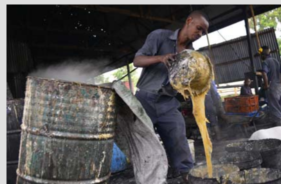
Pouring the binder
