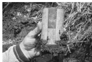
Preparación para extraer la muestra de suelo sin destruir el material
