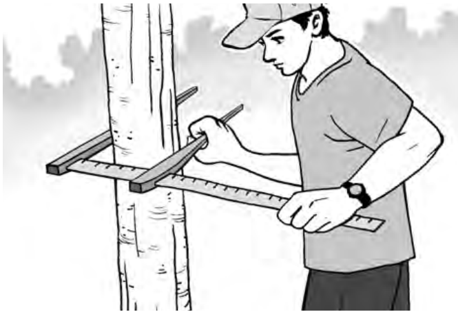
Figura 18. Ilustración de medición del diámetro a la altura del pecho utilizando forcípula en un individuo de pequeño porte
