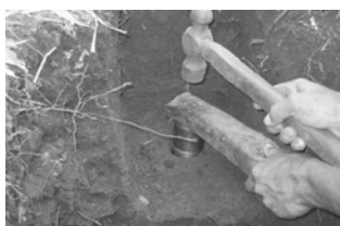
Penetración de los cilindros
