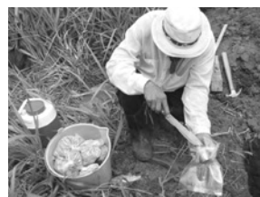
Extracción del suelo del cilindro para ser depositado en un saco
