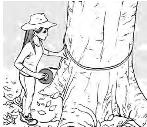
Figura 44. Medición del dap utilizando cinta diamétrica
