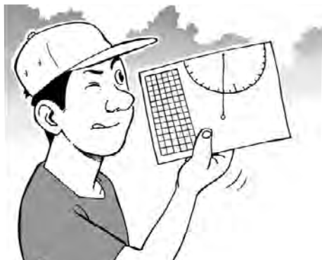
Figura 23. Medición de la altura utilizando un clinómetro de papel
