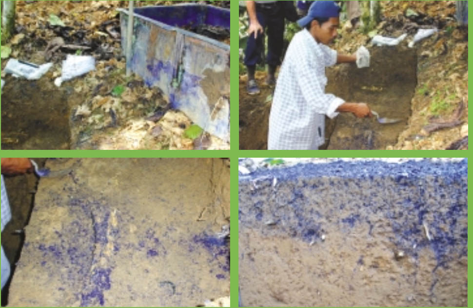
Gambar 18: Kegiatan pengukuran jumlah pori makro di lapangan menggunakan larutan methylen blue (keterangan searah jarum jam) cairan disiramkan ke dalam bingkai plastik sekitar 6 jam sebelum pengamatan (Atas kiri), lapisan tanah dipotong per kedalaman 10 cm (Atas kanan), Sebaran bercak biru menunjukkan sebaran pori makro tanah pada bidang horizontal (bawah kiri), sebaran pori makro tanah pada bidang vertikal (bawah kanan). (Foto: Meine van Noordwijk & Kurniatun Hairiah).
